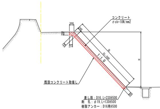
※裏法被覆工の打換え工は、防潮堤背後の保有人や隣接する民家に影響を及ぼさないよう堤体の安定性に留意し施工を行うものとし、施工が難しいと判断される場合は、監督員と協議し、施工範囲の調整を行うものとする。
