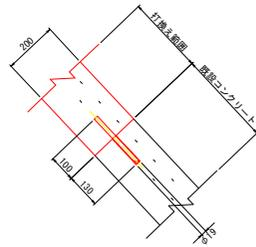
※既設コンクリートとの打継目には差し筋アンカーを施工する。
